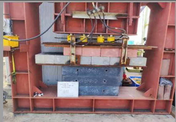
②-4 試験完了後写真 (異常なし)
